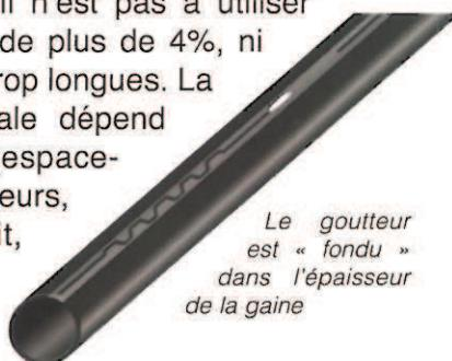
Certaines marques proposent un goutteur conçu comme le goutteur à chicane simple mais fabriqué dans un polymère « à mémoire de forme » qui joue le rôle de régulateur. Il permet d'avoir des longueurs de rampes plus grandes; mais, il est aussi recommandé de l'utiliser dans des pentes inférieures à 4%.
